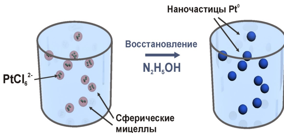
Рисунок 3.13.1 – Схематическая иллюстрация процесса синтеза наночастиц платины
